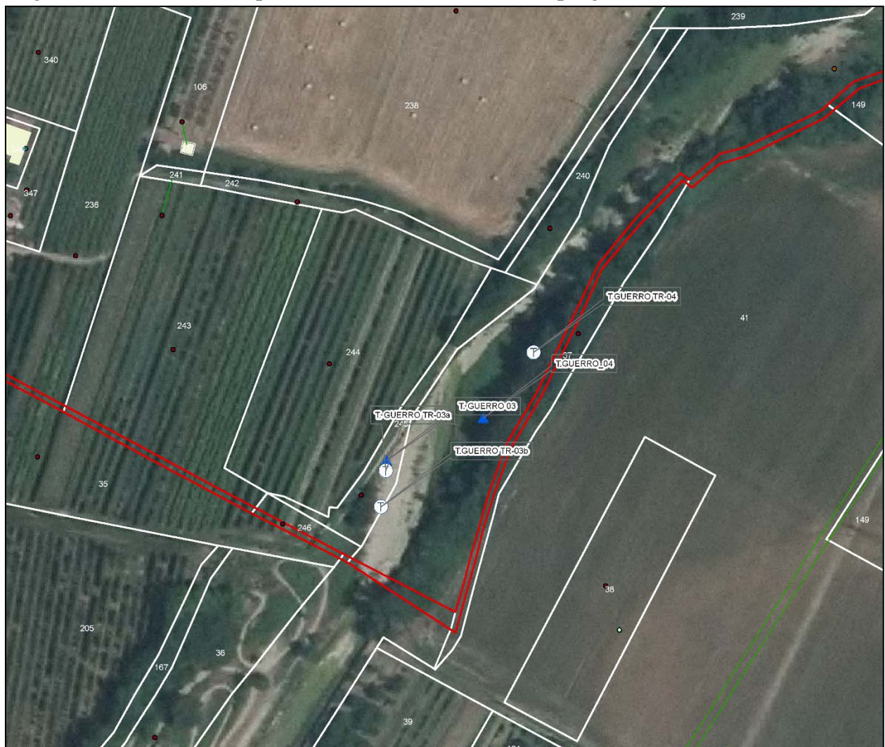
Figura 9.1: Ubicazioni delle indagini realizzate in corrispondenza dell'intervento del ponte sul Torrente Guerro e dei sottopassi agricoli. I sondaggi sono rappresentati con un triangolo di colore blu, le acquisizioni sismiche HVSR sono rappresentate invece con la lettera "T" all'interno di un cerchio.
