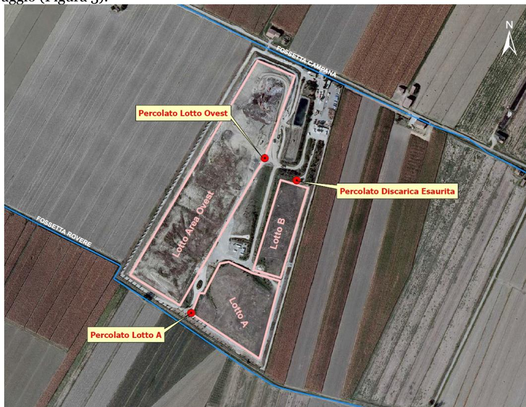
**Figura 3** - Planimetria Discarica di Aimag di Medolla con rete di monitoraggio delle acque di percolazione.
