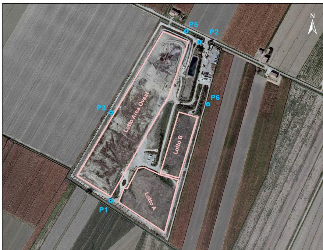
**Figura 1** - Planimetria Discarica di Aimag di Medolla con rete di monitoraggio delle acque di falda.
