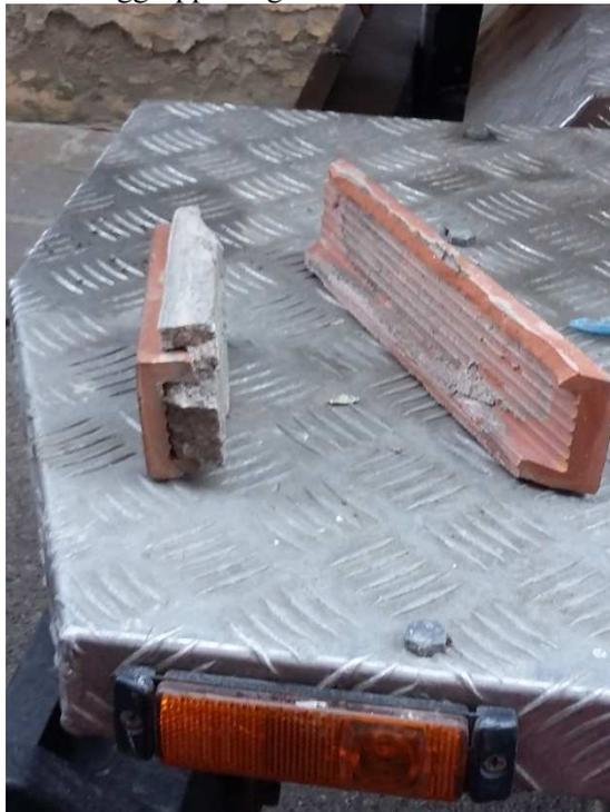
Utilizzando l'analisi termografica e la battitura sono state individuate zone in cui il rivestimento risultava distaccato dal supporto e ciò poteva essere dovuto a varie cause tra cui i cicli di gelo e disgelo, le infiltrazioni, gli anni.
