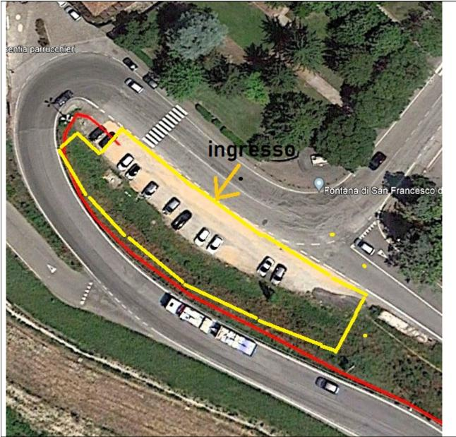
Area di cantiere n°1 – Concordia, SP8. Proprietà: pubblica. La recinzione verrà installata solo verso la SP 8 nel tratto piano. Durante le operazioni di scotico del terreno in scarpata, potrà essere regolato il traffico con senso unico alternato.
